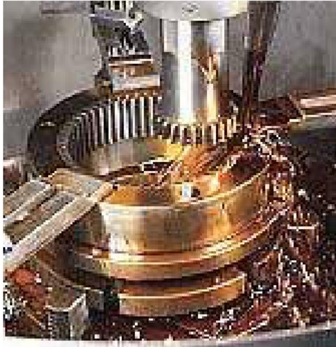
使用 CNC 齒輪刨 齒機加工內齒輪
