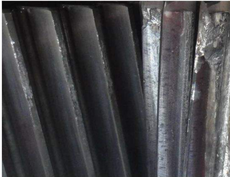
大齒輪齒頂部損傷
